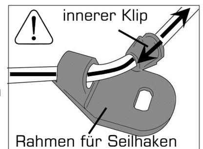
**Hinweis:** Bevor sie den inneren Klip und den Rahmen für den Seilhaken wieder montieren können sie zuerst unter leichter Spannung einen Knoten am mittleren Fuß machen. Dies erleichtert die Montage des Klips und des Rahmnes für den Seilhaken.
