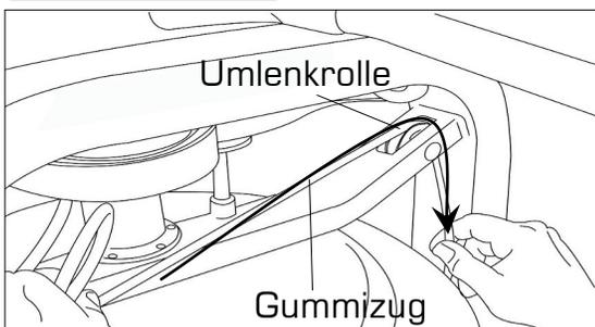
Fädeln sie das Seil (auf der anderen Seite des Leerlaufrades) zurück durch die Umlenkrolle und den mittleren Fuß. Befestigen sie den Rahmen für den Seilhaken wieder und haken sie das Seil am dafür vorgesehenen Haken an der hinteren Querstrebe ein.
