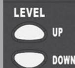
Verwenden Sie die LEVEL UP/ DOWN Tasten in Verbindung mit dem Einstellhebel am Tank um korrekte Werte für 500M / Distanz / CAL / WATT zu erhalten.
