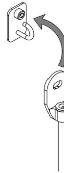
⚠️ Schneiden Sie den Kabelbinder des Gummizugs nicht durch, bevor der Gummizug wie hier abgebildet an der Rückseite des Rudergerätes angebracht ist.
