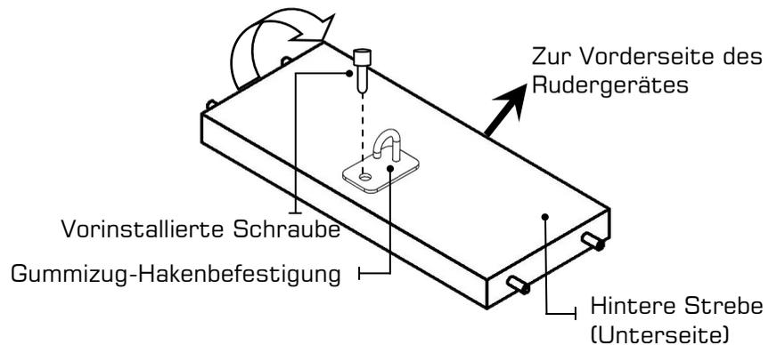
b) Verbinden Sie dann die **seitliche Schiene links** und die **seitliche Schiene rechts** [2] mit 4 x M6x15mm-Schraube [12] und der **hinteren Strebe** [4]. **NICHT FESTZIEHEN**.
