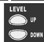
Lassen Sie beim Einstellen des Widerstands Niveaus zwei Schläge eine Zunahme und zehn Schläge eine Abnahme des Widerstands zu
